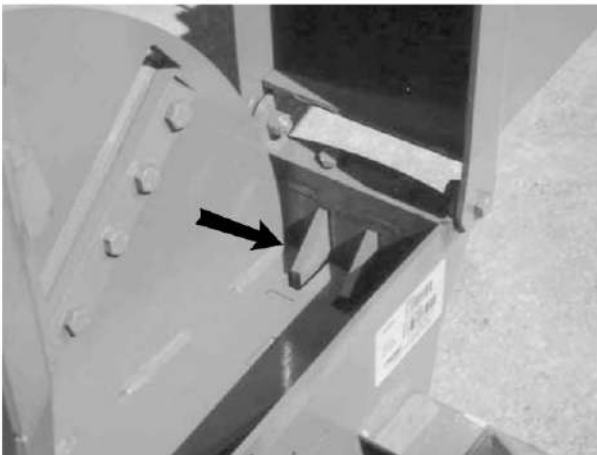
Расположение дробилки внутри роторного отделения
