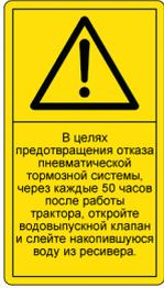
**Положение наклеивания:** на поверхности ресивера пневматического тормоза.
